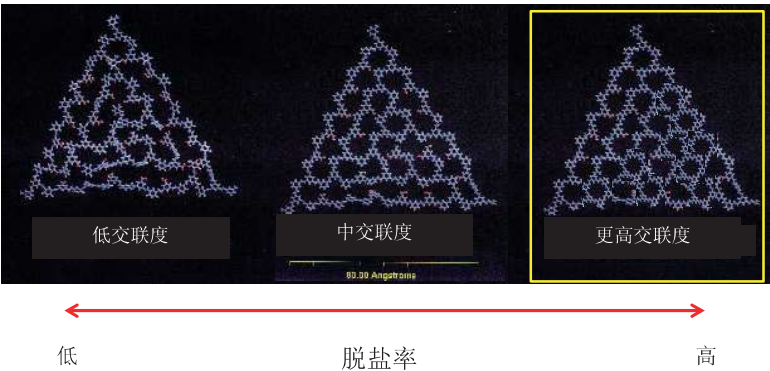
图 1.3 交联结构示意图
