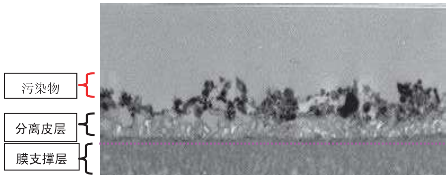
图 1.2 膜表面污染物堆积图
