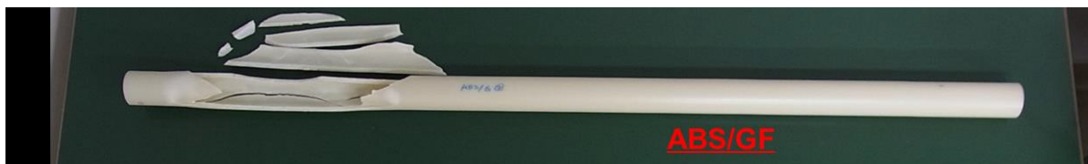
图 9 产水中心管破裂和机械损坏照片
